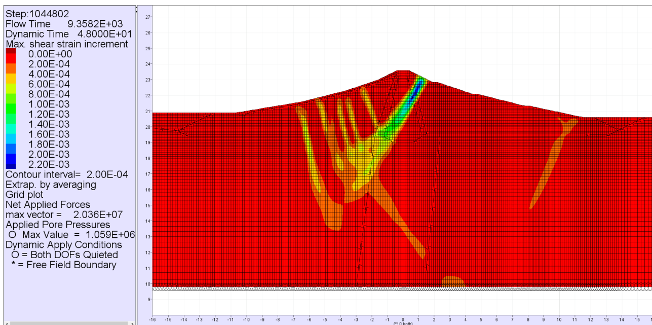
Figura 2.6-5 Campo della deformazione di taglio nella diga – Verifica allo Stato Limite di Collasso – invaso vuoto – input sismico 06 – Mascioni – Campotosto - N.
